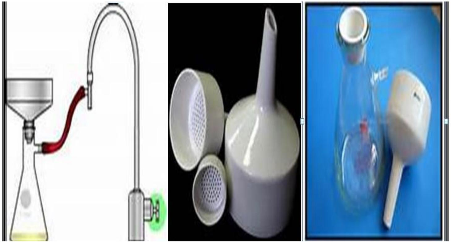
شكل (1) قمع بخنر متصل بمضخة التفريغ
